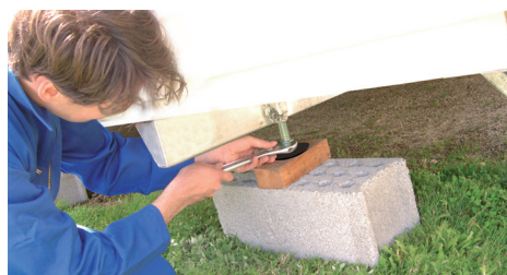
Finaliser le réglage grâce aux vérins à l'aide d'une clef à molette.
